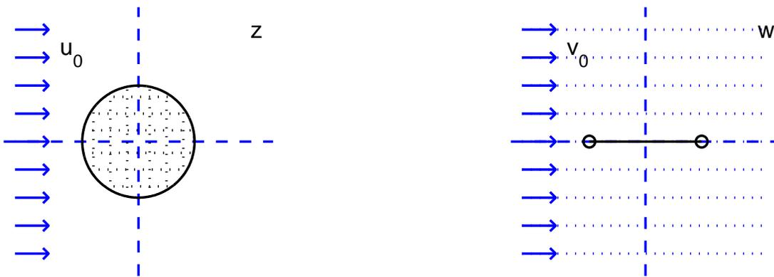
Wegen (5.10) lautet das komplexe Strömungspotential im Bildraum  $\widetilde{\Phi}(w) = -v_0 w$ ,  $w \in \mathbb{C}$ , wobei  $v_0 > 0$  die (konstante) Strömungsgeschwindigkeit im Unendlichen ist. Die Rücktransformation ergibt das Strömungspotential des Ausgangsproblems
