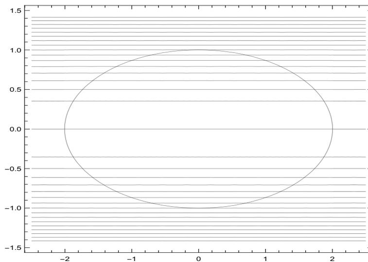
**Bild 2** Nebenbedingung  $g(x, y) := x^2 + 4y^2 - 4 = 0$  mit Höhenlinien der Funktion  $f(x, y) = 2y^2 - 1$
