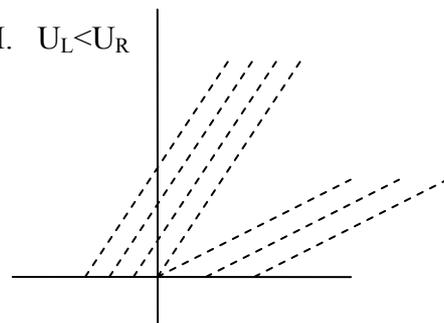
Im ersten Fall schneiden sich die Charakteristiken. Charakteristiken die links von Null starten haben eine „kleinere“ Steigung  $\frac{dt}{dx} = 1/U_L$  als die Charakteristiken welche rechts von Null mit der Steigung  $\frac{dt}{dx} = 1/U_R$  starten.
