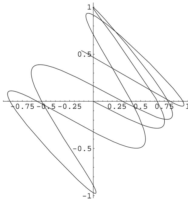
Abbildung 1: Trajektorien gekoppelter Pendel im Konfigurationsraum für  $0 \leq t \leq 20$  und  $v = 1, \epsilon = 0,5$  und  $\omega' = 0,95$
