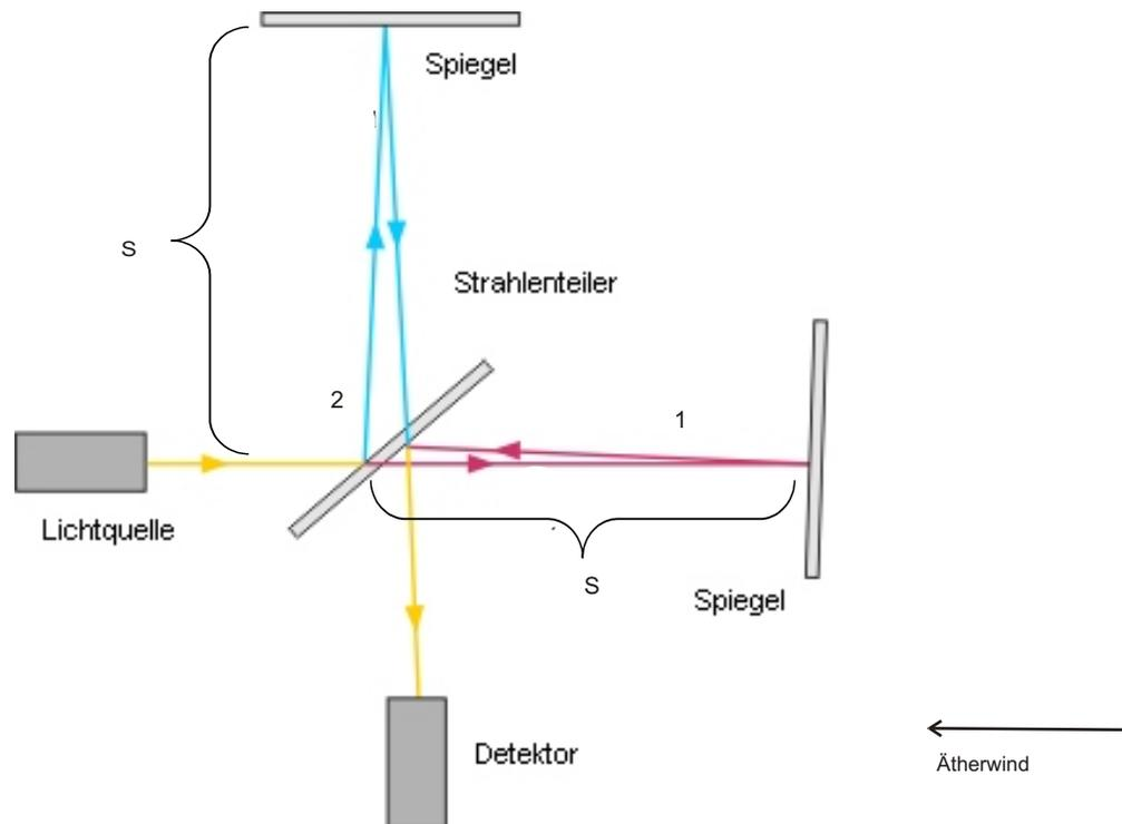
**Erwarteter Ausgang.** Da sich die Erde im Äther bewegt, wird ein sogenannter Ätherwind erzeugt und die Laufzeit des Lichts wird durch den Wind beeinflusst. Mit der Beziehung  $x = vt$  (Weg=Geschwindigkeit\*Zeit) erhalten wir für Weg 1 (rot), Hinweg:
