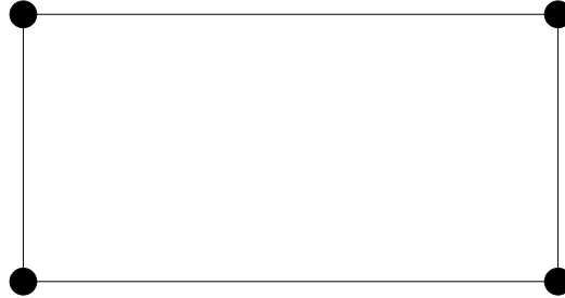
Bild 3.7 Knotenpunkte eines rechteckigen und linearen \mathcal{C}^0 -Elements.
