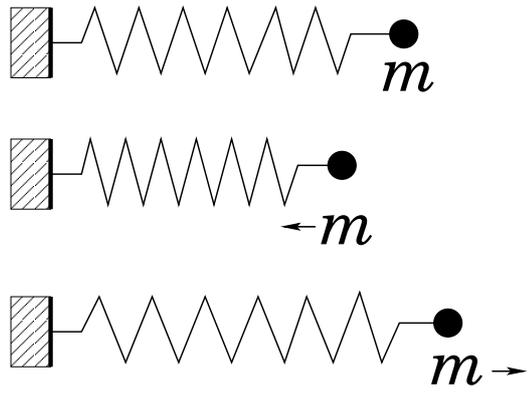
ABBILDUNG 2. Schwingung des Federpendels.
