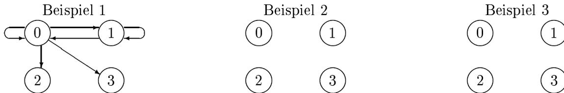
Beispiel 4: Ein Bauteil arbeite max. 5 „Takte“ ( $i$  = Alter bei Taktbeginn), dann Wartung, bei Ausfall Reparatur, danach jeweils Alter 1, hier nur Übergangs-Graph:
